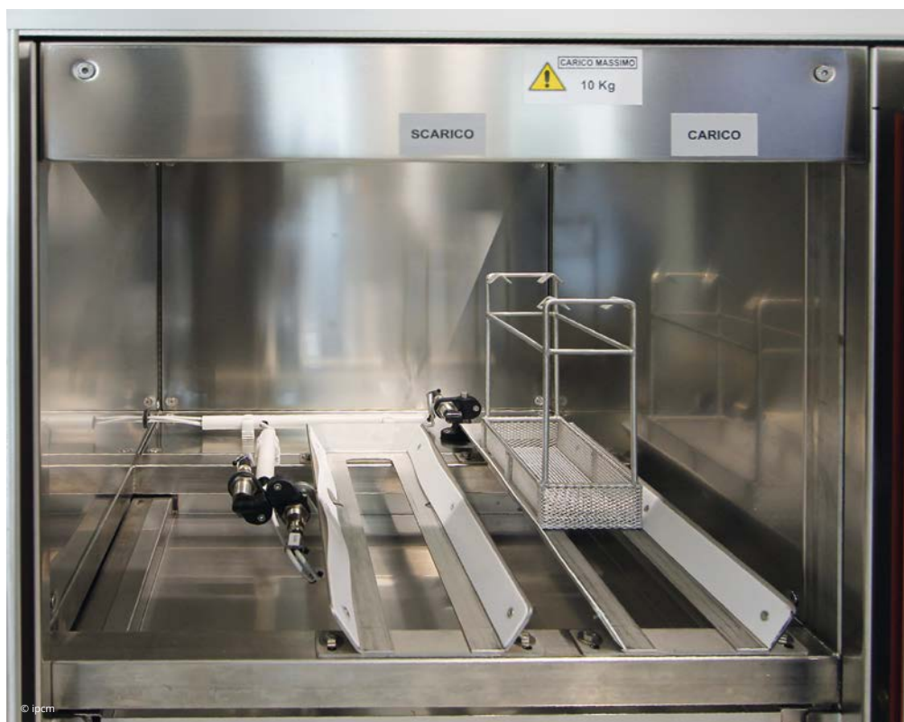
La stazione di carico-scarico dell'impianto dedicato al lavaggio dei componenti.
