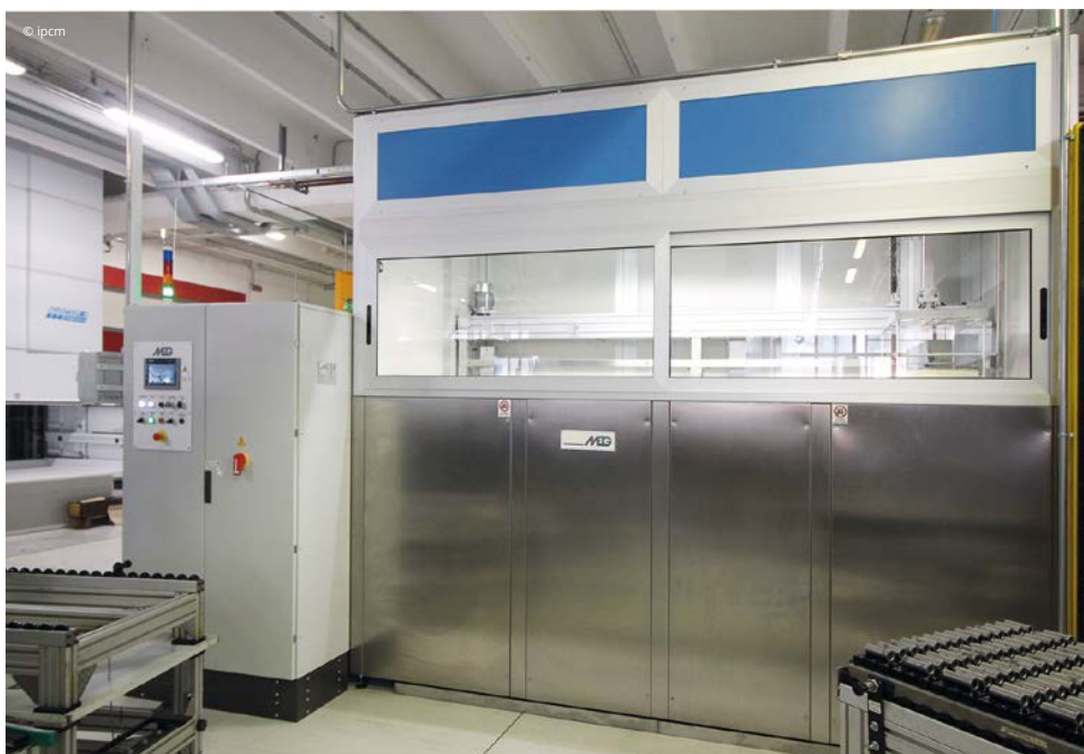
The ultrasonic cleaning machine supplied by Meg and parts to be cleaned to remove residual machining oils. La macchina di lavaggio a ultrasuoni fornita da Meg e dei pezzi da lavare per eliminare gli oli di lavorazione residui.
