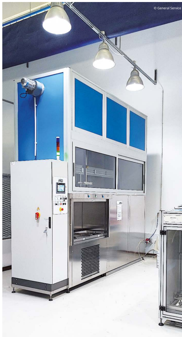
MEG's cleaning machine is composed by three tanks. La macchina di lavaggio di MEG è costituita da 3 vasche.
