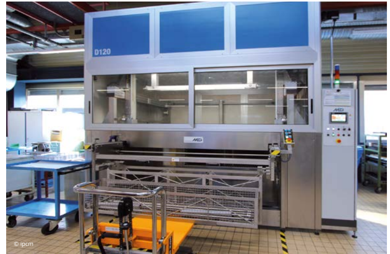
The customised basket to accommodate ROLLVIS' large-sized components and the new-generation HFE solvent cleaning machine provided by MEG S.r.l. Il cesto personalizzato per contenere i componenti di grandi dimensioni di ROLLVIS e la macchina di lavaggio con solventi di nuova generazione HFE di MEG S.r.l.
