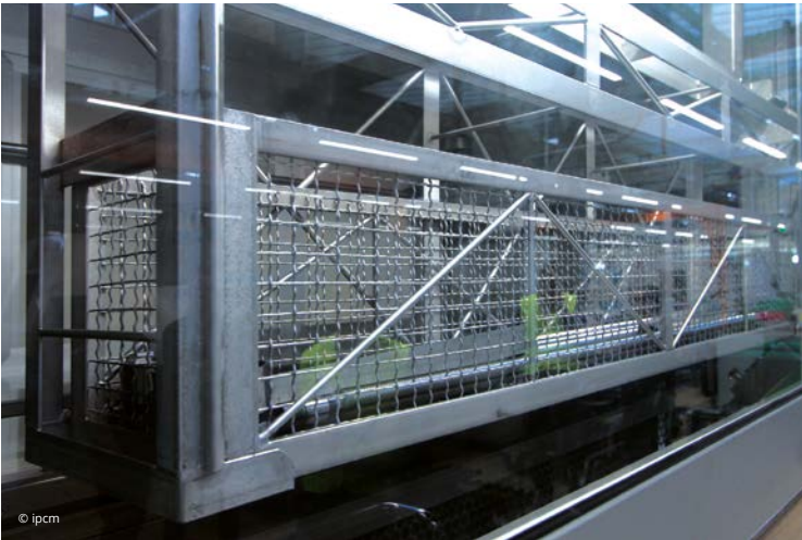
The customised basket to accommodate ROLLVIS' large-sized components and the new-generation HFE solvent cleaning machine provided by MEG S.r.l. Il cesto personalizzato per contenere i componenti di grandi dimensioni di ROLLVIS e la macchina di lavaggio con solventi di nuova generazione HFE di MEG S.r.l.
